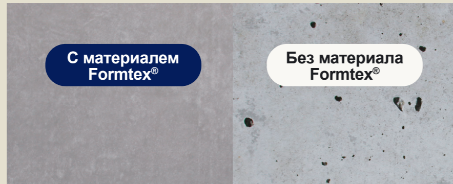
Formtex® отводит излишки воды и воздуха, что делает бетонное покрытие более компактным ввиду отсутствия пузырьков воздуха. Результат – повышенная стойкость против разрушения, вызываемого проникновением хлоридов, воды, углекислого газа и мороза/таяния.
