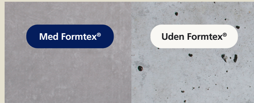
Formtex® dræner overskydende vand og luft, hvilket giver et tættere betondæklag uden blærer og dermed også øget modstandsdygtighed over for nedbrydning ved indtrængning af klorider, vand, kuldioxid og ved frost/tø.
