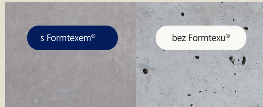
Formtex® odvádí přebytečnou vodu a vzduch a zajišťuje tak kompaktnější betonové krytí bez vzduchových bublin. Výsledkem je zvýšená odolnost vůči degradaci způsobené pronikáním chloridů, vody, oxidu uhličitého a mrazu/tání.
