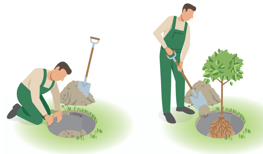
Fibertex RootSeal Premium s'installe facilement à la verticale le long du bord du trou.
