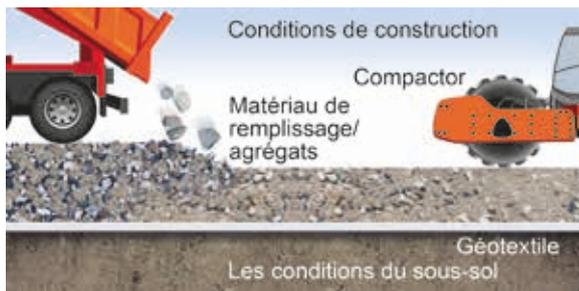
Figure 6.15: Exemple d'une plateforme routière- conception et mise en œuvre
