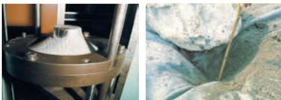
Figure 6.4: Résistance au poinçonnement statique (essai CBR) comparé à la mise en œuvre sur site
