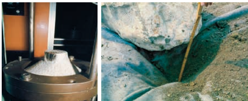
Abbildung 6.4 Statischer Durchdrückwiderstand (CBR-Versuch) im Vergleich zu existierenden Verlegungen
