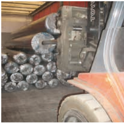
Abbildung 8.1 Abladen der Rollen mit Gabelstapler mit montiertem Aufsatz
