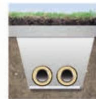
Colocando um geotêxtil Fibertex no fundo de uma vala aumenta consideravelmente a capacidade de carga da mesma.
