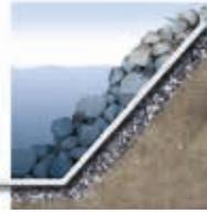
Os geotêxteis Fibertex protegem a linha costeira, suportando o impacto das ondas e das correntes, prevenindo a erosão.
