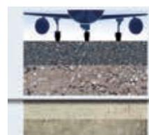
Nas construções sujeitas a grandes pressões, os geotêxteis Fibertex estabilizam as camadas de fundação, permitindo o suporte das cargas dinâmicas.
