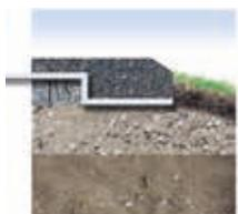
Os geotêxteis Fibertex asseguram a separação e estabilidade entre o subsolo e as camadas da estrada.
