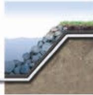
A membrana impermeável é protegida da perfuração pela aplicação de geotêxteis Fibertex.
