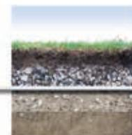
Campos relvados; courts de ténis; zonas com gravilha, são estabilizados com a aplicação de geotêxteis Fibertex, já que a drenagem efectiva assegura uma superfície uniforme.
