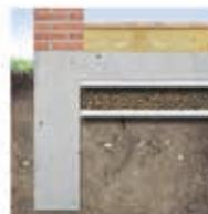
Sob os pavimentos em betão, o geotêxtil Fibertex, permeável, protege a camada drenante da contaminação pelo betão e pelas partículas de solo.
