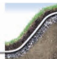
Com os geotêxteis Fibertex sob a camada superficial, o talude suportará a água do subsolo, água da chuva e água proveniente do degelo que, de outra forma, fariam a lavagem dos finos, instabilizando o talude.
