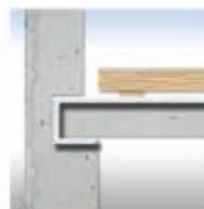
Em edifícios de apartamentos, os geotêxteis Fibertex são usados como camada supressora do som.
