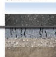
O Fibertex AM-2 saturado em betuminoso, absorve as tensões das fissuras existentes na superfície antiga, não permitindo a sua reflexão através das camadas de desgaste.
