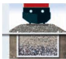
O aumento rápido de velocidade e o peso dos comboios requer camadas de suporte extremamente resistentes. Os geotêxteis Fibertex estabilizam as camadas de fundação, permitindo o maior suporte de cargas dinâmicas.
