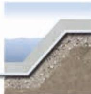
As barragens, represas e os diques artificiais necessitam de reforço para que possam resistir às correntes, etc. A aplicação dos geotêxteis Fibertex permite a estabilização da construção, prolongando a vida útil da construção.
