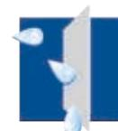
As propriedades hidráulicas dos geotêxteis Fibertex foram concebidas para drenar o excedente de água para fora das construções; não pela passagem de água através do geotêxtil, mas ao longo do plano do mesmo, retirando-a do sistema. A utilização de geotêxteis em drenagens, assegura a drenagem contínua de fluidos com perdas mínimas de pressão.
