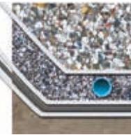
Os geotêxteis Fibertex protegem as membranas como foi descrito anteriormente. Também são utilizados nas camadas detectoras de fugas.
