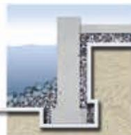
Os geotêxteis Fibertex colocados atrás da parede de retenção mantêm a camada de drenagem desobstruída, o que alivia a pressão hidráulica exercida na parede. Quando colocados à frente da parede, os geotêxteis Fibertex previnem a remoção dos sedimentos do fundo.
