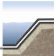
Os geotêxteis Fibertex protegem as membranas impermeáveis da perfuração.
