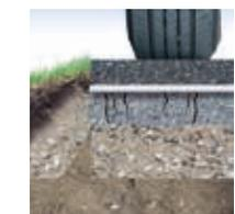
O Fibertex AM-2 saturado em betuminoso previne a penetração das águas superficiais na camada de base, e consequente lavagem dos finos, reduzindo
