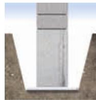
Quando colocados sob as fundações, os geotêxteis Fibertex substituem a camada de ligação (entre a fundação e o subsolo). É simples, eficaz e económico.
