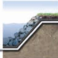
Les Géotextiles Fibertex protègent la membrane imperméable contre la perforation.
