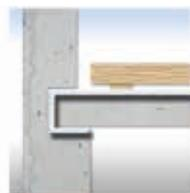
Dans les immeubles, les Géotextiles Fibertex sont utilisés dans le but de réduire le bruit d'impact.
