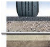
Les Géotextiles Fibertex, en séparant les différentes couches de matériaux, stabilisent les chaussées qui sont conçues pour résister aux contraintes dynamiques et statiques.
