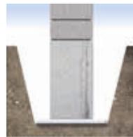
Quand ils sont placés sous les fondations, les Géotextiles Fibertex remplacent la couche anticontaminante. C'est simple, efficace et économique.
