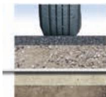
Les aires soumises à des charges statiques considérables exigent une couche de base stable, ce qui est assuré par les Géotextiles Fibertex, qui, en séparant les différentes couches de matériaux, jouent un rôle essentiel pour maintenir la portance.
