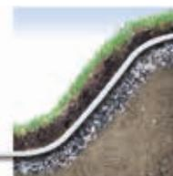
Grâce à la mise en place des Géotextiles Fibertex sous la couche de couverture, le talus pourra résister aux eaux souterraines, eaux de pluie et de fonte qui, autrement, lessiveraient les fines particules.
