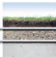
Les Géotextiles Fibertex sont utilisés comme couche de séparation, de protection mécanique des membranes du toit ainsi que comme filtre pour protéger toute couche drainante.
