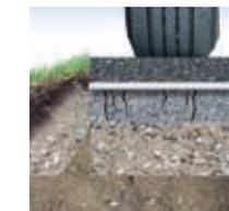
La nappe Fibertex AM-2 saturée de bitume, en empêchant l'eau de surface de pénétrer dans la couche de base, évite le lessivage des fines et réduit considérablement l'apparition de fissures et de crevasses.
