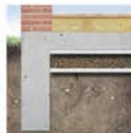
Au-dessous des dalles en béton, le Géotextile Fibertex perméable protège la couche drainante contre la contamination du béton et du sous-sol.
