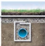
Les drains de surface risquent d'être colmatés par le sol environnant. Les Géotextiles Fibertex maintiennent les fines séparées de la couche drainante et assurent ainsi l'efficacité du système de drainage.
