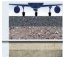
Dans les ouvrages où la surface est soumise à de très fortes sollicitations, les Géotextiles Fibertex stabilisent les fondations leur permettant ainsi de résister aux charges dynamiques.
