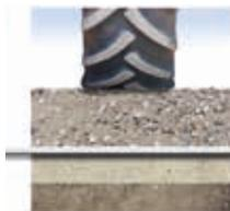
Les Géotextiles Fibertex, placés sous le revêtement constitué de gravillons, augmentent la portance de la route et lui permettent ainsi de résister aux charges permanentes d'un trafic intense. Aucune voiture, aucun tracteur ni autres véhicules ne restent collés aux gravillons.
