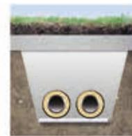
Un Géotextile Fibertex placé au fond d'une tranchée augmente la portance considérablement.
