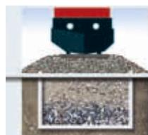
La rapidité et le poids sans cesse croissants des trains soumettent la couche de base à des sollicitations extrêmement importantes. Les Géotextiles Fibertex stabilisent les fondations leur permettant ainsi de résister aux charges dynamiques.
