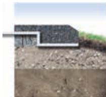
Les Géotextiles Fibertex assurent séparation et stabilité entre le sous-sol et les matériaux d'apport destinés à la construction de la route.
