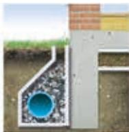
Fibertex asegura un drenaje limpio y efectivo en la construcción de cimentaciones y muros, evitando los daños producidos por la humedad.
