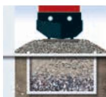
Los trenes, cada día más rápidos y pesados, requieren instalaciones con capas de soporte más estables. Los geotextiles Fibertex estabilizan la capa de soporte para soportar las cargas dinámicas.
