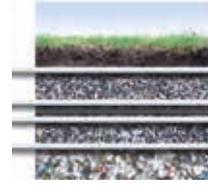
En los vertederos controlados el geotextil Fibertex, a ambos lados de la geomembrana, la protege contra la perforación. Además, los geotextiles Fibertex se emplean como filtro en las capas de drenajes de fluidos.
