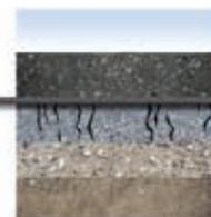
El geotextil Fibertex AM-2 saturado de betún absorbe las tensiones en las grietas o juntas de la antigua superficie y evita la reflexión en las nuevas capas de firme.
