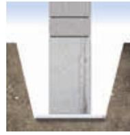
Debajo de los cimientos el geotextil Fibertex tiene una función de limpieza, simple y efectiva, que evita el desperdicio de hormigón.
