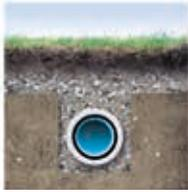
La permeabilidad de los geotextiles Fibertex alrededor de la tubería asegura un efectivo sistema de drenaje sin riesgos de colmatación.
