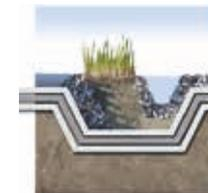
La membrana impermeable de la balsa puede protegerse contra el punzonamiento a ambos lados con los geotextiles
