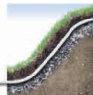
Un geotextil Fibertex colocado bajo la capa superior de un talud evitará que los finos sean arrastrados por el agua del subsuelo, de la lluvia o de la nieve.
