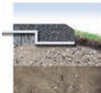
Los geotextiles Fibertex garantizan una separación y estabilidad entre el suelo natural y los materiales aportados.
