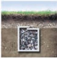
Los geotextiles Fibertex son ideales en este sistema, al proteger y evitar que el terreno adyacente contamine el propio dren.
