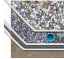
Como se menciona anteriormente el geotextil Fibertex a ambos lados de la geomembrana la protege de perforaciones. Los geotextiles Fibertex también facilitan la detección de fugas.
