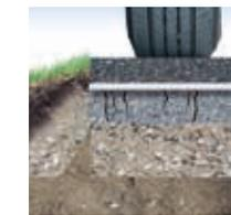
El geotextil Fibertex AM-2 impregnado de betún evita que el agua penetre desde la superficie hacia las capas inferiores con la consiguiente pérdida de finos y de la capacidad portante.
