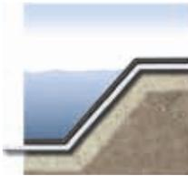
Los geotextiles Fibertex protegen la membrana impermeable frente a la perforación.
