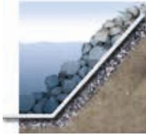
Los geotextiles Fibertex protegen las costas gracias a su flexibilidad y permeabilidad, que permiten la acción de las olas sin riesgo de erosión ni eliminación de partículas finas bajo las defensas.
