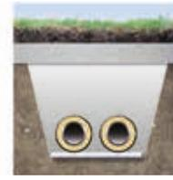
La colocación de un geotextil Fibertex en la base de la zanja mejora la capacidad portante. Se eliminan los problemas de asentamiento.
