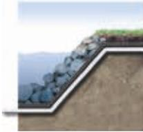
Los geotextiles Fibertex protegen las geomembranas contra cualquier perforación. La utilización de un geotextil impregnado de betún puede hacer las funciones
