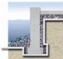
Los geotextiles Fibertex dispuestos tras el tabla-estacado, protegen y mantienen limpia la capa drenante que reduce la presión hidráulica sobre la pared. Delante de la pared los geotextiles Fibertex evitan la erosión del lecho marino.
