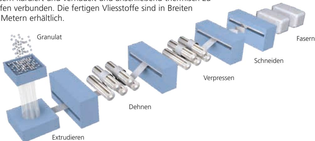
Abbildung 2.1 Grafische Darstellung der Faserproduktion
