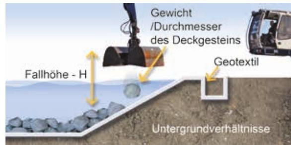
Abbildung 6.10 Beispiel eines Wasserbauwerks – Verlegung und Entwurf
