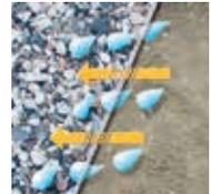
In Abbildung 5.3 werden die Funktionsmerkmale zur Beschreibung der Funktionen Filtration und Trennung aufgeführt. Die wichtigsten Funktionsmerkmale sind die charakteristische Öffnungsweite und die Wasserdurchlässigkeit normal zur Ebene.
