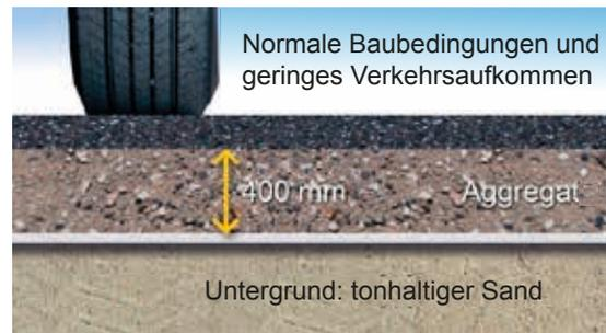
Abbildung 6.12 Beispiel eines Straßenbauwerks – Verlegung und Entwurf
