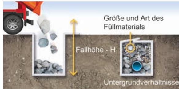
Abbildung 6.8: Beispiel eines Entwässerungsgrabens – Verlegung und Entwurf
