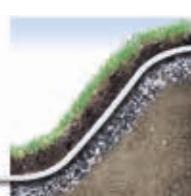
Благодаря слою геотекстиля Fibertex, уложенному под верхним слоем склона, обеспечивается его защита от разрушения почвенными, дождевыми и талыми водами, которые вымывают мелкозернистый материал.
