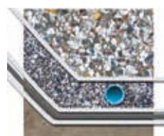
Как указано выше, геотекстили Fibertex с обеих сторон защищают мембранны от разрывов, а также способствуют обнаружению протечек.
