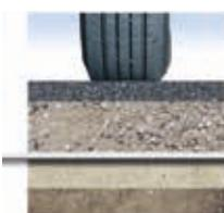
Твёрдые, статично нагруженные поверхности требуют стабильной основы. Геотекстиль Fibertex Geotekstiler разделяет слои из различных материалов, обеспечивая, тем самым высокую несущую способность.
