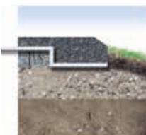
Геотекстили Fibertex обеспечивают разделение и стабильность между основанием и верхними компонентами дороги.
