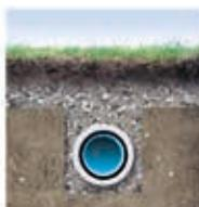
Укладка водонепроницаемого геотекстиля Fibertex вокруг дренажной трубы обеспечивается эффективность и долговечность дренажа, защищённого от засорения.
