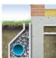
При строительстве фундаментов и подвалных стен геотекстиль Fibertex обеспечивает чистоту и эффективность окружающей дренажной системы, защищая здание от сырости.
