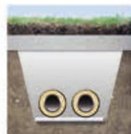
При размещении геотекстиля Fibertex на дне траншеи обеспечивается стабильное и устойчивое основание.
