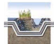
При установке с обеих сторон водонепроницаемых мембранны геотекстили Fibertex защищают сооружение от разрывов.
