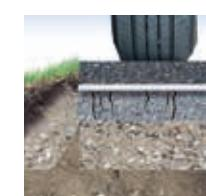
Благодаря битумной пропитке Fibertex AM-2 не даёт воде проникать вниз, в несущие слои, тем самым защищая содержащиеся в них мелкозернистые материалы от вымывания. Это снижает риск появления трещин и выбоин в поверхности.
