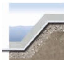
При строительстве запруды используются тяжёлые и прочные материалы. Дамбы и плотины стабилизируются при помощи геотекстилей Fibertex, которые обеспечивают защиту мелкозернистого материала от вымывания.
