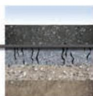
Пропитанная битумом ткань Fibertex AM-2 выравнивает напряжения от трещин и швов в старой поверхности покрытия и препятствует их повторному образованию на композитном верхнем слое Densiphalt.
