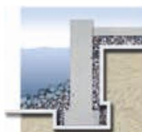
Уложенные под причальной стенкой геотекстили Fibertex защищают дренажный слой, снимая часть водяного давления на стенку. Если геотекстили Fibertex уложены перед причальной стенкой, они защищают морское дно от размывания.
