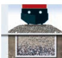
Вследствие увеличения массы и скорости движения железнодорожных составов, несущие слои железных дорог подвергаются все более существенным нагрузкам. Геотекстиль Fibertex стабилизирует основание, благодаря
