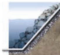
Геотекстили Fibertex защищают береговую полосу, так как благодаря их гибкости и водонепроницаемости воздействие волн и течений не вызывает эрозии и размывания самого берега.
