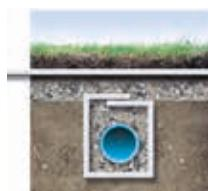
При устройстве поверхностного дренажа существует риск его засорения частицами земли. Геотекстиль Fibertex препятствует проникновению мелкозернистого материала в дренажный слой и тем самым обеспечивает эффективность дренажной системы.
