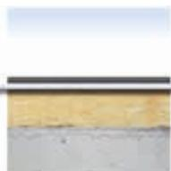
В конструкции крыши геотекстиль Fibertex используется в качестве опорного слоя, механической защиты мембран крыши, а также как защитный фильтр дренажного слоя.
