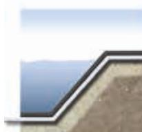
Геотекстили Fibertex защищают водонепроницаемую мембрану от разрывов.
