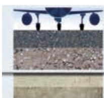
В конструкциях, покрытие которых испытывает сильные нагрузки, геотекстиль Fibertex стабилизирует несущие слои, благодаря чему они противостоят динамическим нагрузкам.
