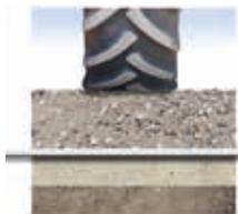
Os geotêxteis Fibertex colocados por baixo da camada superficial de gravilha, aumentam a capacidade de carga da estrada no que respeita a resistir ao tráfego pesado. Nenhum carro,
