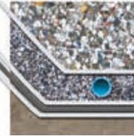
Os geotêxteis Fibertex protegem as membranas como foi descrito anteriormente. Também são utilizados nas camadas detectoras de fugas.
