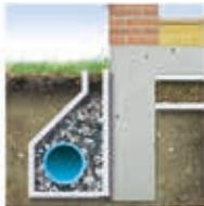
Na construção de fundações e paredes subterrâneas, os geotêxteis Fibertex asseguram uma drenagem circunferencial eficiente, o que vai prevenir, por exemplo, danos causados pela humidade.
