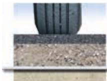
Através da separação de diferentes camadas de material, os geotêxteis Fibertex estabilizam as camadas da estrada, cuja construção tem por objectivo resistir a tensões dinâmicas e estáticas que se farão sentir durante o tempo de vida da estrutura.
