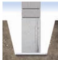
Quando colocados sob as fundações, os geotêxteis Fibertex substituem a camada de ligação (entre a fundação e o subsolo). É simples, eficaz e económico.
