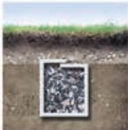
Os geotêxteis Fibertex protegem o sistema de drenagem, já que impedem a mistura de finos.
