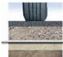
Áreas sujeitas a consideráveis pressões estáticas requerem uma base estável. Os geotêxteis Fibertex permitem-no já que separam as diferentes camadas de material, o que
