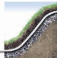
Com os geotêxteis Fibertex sob a camada superficial, o talude suportará a água do subsolo, água da chuva e água proveniente do degelo que, de outra forma, fariam a lavagem dos finos, instabilizando o talude.
