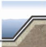
Os geotêxteis Fibertex protegem as membranas impermeáveis da perfuração.
