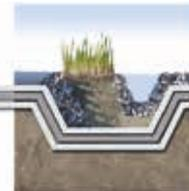
Os geotêxteis Fibertex colocados de ambos os lados da membrana impermeável, protegem o sistema das perfurações.
