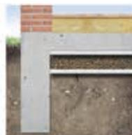
Sob os pavimentos em betão, o geotêxtil Fibertex, permeável, protege a camada drenante da contaminação pelo betão e pelas partículas de solo.
