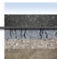
O Fibertex AM-2 saturado em betuminoso, absorve as tensões das fissuras existentes na superfície antiga, não permitindo a sua reflexão através das camadas de desgaste.
