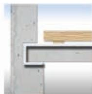
Em edifícios de apartamentos, os geotêxteis Fibertex são usados como camada supressora do som.
