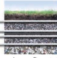
Em aterros sanitários vigiados, os geotêxteis Fibertex colocados em ambas as faces das membranas, protegem-nas de serem perfuradas. Além disso, os geotêxteis Fibertex são usados como filtro protector das camadas de drenagem.
