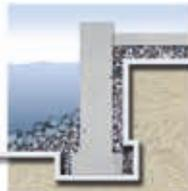
Os geotêxteis Fibertex colocados atrás da parede de retenção mantêm a camada de drenagem desobstruída, o que alivia a pressão hidráulica exercida na parede. Quando colocados à frente da parede, os geotêxteis Fibertex previnem a remoção dos sedimentos do fundo.
