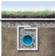
Há uma grande probabilidade da drenagem superficial ser impedida por acumulação de material fino proveniente do solo envolvente. Os geotêxteis Fibertex mantêm os finos separados da camada de drenagem, garantindo assim a eficácia do sistema de drenagem.
