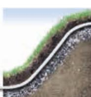
Med Fibertex Geotekstiler under det øverste lag kan skræningen modstå grundvand, regnvand og smeltevand, der ellers ville vaske finkornet materiale bort.
