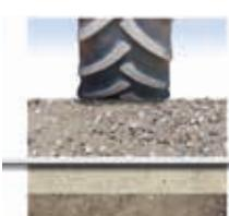
Fibertex Geotekstiler under grusbelægningen øger vejens bæreevne, så den kan modstå vedvarende tung trafikbelastning. Biler, traktorer eller andre køretøjer kører derfor ikke fast i gruslaget.
