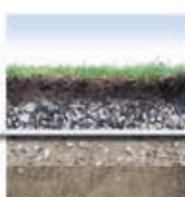
Græsbaner, cindersbaner, grusbaner og jordbaner stabiliseres med Fibertex Geotekstiler. De sikrer en effektiv dræning, hvorfed en jævn overflade bevares.
