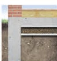
Under terrændæk beskytter de vandgennemtrængelige Fibertex Geotekstiler drænlaget mod forurening fra beton og underbund.
