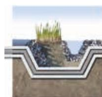
Placeret på begge sider af de vandtætte membraner beskytter Fibertex Geotekstiler anlægget mod perforering.
