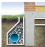
Ved konstruktion af fundamenter og kældervægge sikrer Fibertex Geotekstiler et rent og effektivt omfangsdræn, der bl.a. forhindrer fugtskader.
