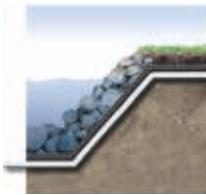
Den vandtætte membran beskyttes mod perforering med Fibertex Geotekstiler.
