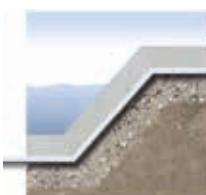
Når der kunstigt dæmmes op for naturens kræfter, skal der tunge og sterke materialer til. Diger og dæmninger stabiliseres med Fibertex Geotekstiler, der sikrer, at finkornet materiale ikke udvaskes.
