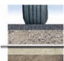
Hårdt statisk belastede arealer kræver et stabilt underlag. Fibertex Geotekstiler separerer de forskellige matrielle lag og sikrer dermed bæreevnen.
