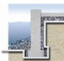
Bag støttemuren beskytter og renholder Fibertex Geotekstiler drænlaget, hvilket aflaster muren/væggen for vandtryk. Når Fibertex Geotekstiler er placeret foran støttemuren/væggen, forhindrer de udvaskning af havbunden.
