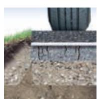
Fibertex AM-2 – mættet med bitumen – forhindrer overfladevand i at trænge ned i de bærende lag, der sikres mod udvaskning af finkornet materiale. Dette reducerer fremkomsten af revner og krakelinger.
