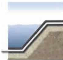
Fibertex Geotekstiler beskytter den vandtætte membran mod perforering.
