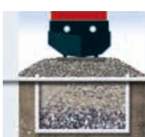
De fortsat hurtigere og tungere tog udsætter bærelagene for kraftige belastninger. Fibertex Geotekstiler stabiliserer underbunden, så den kan modstå de dynamiske belastninger.
