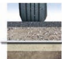
Ved at separere de forskellige matrielle lag stabiliserer Fibertex Geotekstiler vejkonstruktioner, der er dimensioneret til at modstå dynamiske og statiske belastninger.
