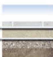
Fibertex Geotekstiler forhindrer migrering eller tab af finkornet materiale i bærelaget såvel som tilstopning af drænlaget
