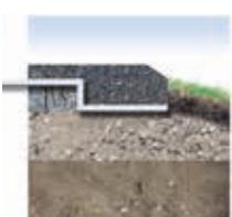
Fibertex Geotekstiler sikrer separering og stabilitet mellem underbund og tilførte vejbygningsmateriale.
