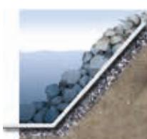
Fibertex Geotekstiler beskytter kysten, da deres fleksibilitet og vandgennemtrængelighed tillader bølge- og strømpåvirkninger uden risiko for erosion og udvaskning af selve kysten
