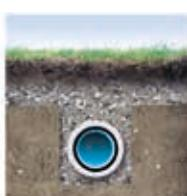
Med et vandgennemtrængeligt Fibertex Geotekstil omkring drænrør sikres et effektivt og holdbart drænsystem uden risiko for tilstopning.
