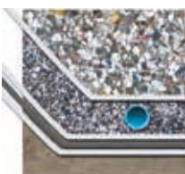
Som beskrevet ovenfor beskytter Fibertex Geotekstiler membranerne på begge sider mod perforering og bidrager også til sporing af udslip.
