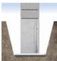
Under fundamenter erstatter Fibertex Geotekstiler et renselag. Det er enkelt, effektivt og økonomisk.
