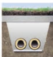
Når Fibertex Geotekstil er placeret i bunden af udgravingen, sikrer det et stabilt og bæredygtigt underlag
