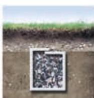
Fibertex Geotekstiler beskytter drænsystemet mod migrering af finkornet materiale.
