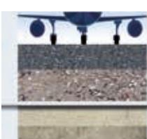
I konstruktioner, hvor belægningen er utsat for kraftige belastninger, stabiliserer Fibertex Geotekstiler bærelagene, så de kan modstå de dynamiske belastninger.
