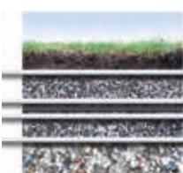
I overvægede affaldsdepoter beskytter Fibertex Geotekstiler membranerne på begge sider mod perforering. Desuden anvendes Fibertex Geotekstiler som beskyttende filter ved drænlagen.
