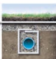
Der er risiko for, at overfladedræn tilstoppes af den omkringliggende jord. Fibertex Geotekstiler forhindrer, at finkornet materiale trænger ind i drænlaget og sikrer drænsystemets effektivitet.
