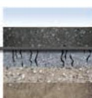
Den bitumenmættede dug Fibertex AM-2 udliner spændinger fra revner og samlinger i den gamle belægningsoverflade og forhindrer, at disse reflekterer op gennem Densiphalt komposit-slidlaget.
