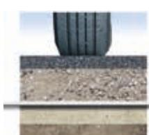
Plochy vystavené značnému statickému zatížení vyžadují stabilní nosnou vrstvu. Geotextile Fibertex zajíždí stabilní nosnou vrstvu separaci různých vrstev materiálu.
