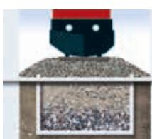
Prudce vzrůstající rychlosť a hmotnost vlaků klade vysoké nároky na nosnou vrstvu. Geotextile Fibertex stabilizují základy a umožňují jim vydržet dynamická zatížení.
