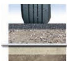
Oddělením různých vrstev materiálů stabilizují geotextile Fibertex silniční konstrukce, které jsou projektovány tak, aby odolávaly dynamickému a statickému namáhání.
