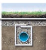
Povrchové drenáže bývají často zaplavovány okolní zeminou. Geotextilie Fibertex udržuje jemnou frakci mimo drenážní vrstvu a zajišťuje tak účinnost drenážního systému.
