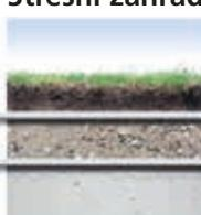
Geotextile Fibertex slouží k separaci vrstev, mechanické ochrane střešních fólií a jako filtrační ochrana všech drenážních vrstev.
