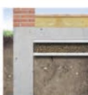
Pod betonovou podlahou chrání propustná geotextile Fibertex drenážní vrstvu před znečištěním betonem a základním podložím.
