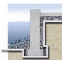
Geotextilie Fibertex instalovaná za opěrnou zeď udržuje drenážní vrstvu čistou a odlehčuje tak hydraulický tlak na zeď. Když je položena před opěrnou zeď, brání geotextilie Fibertex vyplavování mořského dna.
