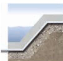
Uměle vystavěné přehrady a hráze musí být zpevným pevným materiálem, aby odolávaly přírodním vlivům. Geotextilie Fibertex mají stabilizační funkci a brání vyplavování jemné frakce.
