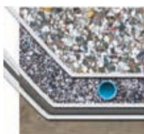
Jak je uvedeno výše, chrání geotextilie Fibertex folii z obou stran proti protržení. Geotextilie Fibertex také pomáhají zjistit průsaky.
