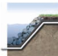
Vodotěsná fólie je chráněna před protržením geotextiliemi Fibertex.
