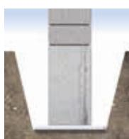
Podložením základů nahrazují geotextile Fibertex podkladovou vrstvu. Jde o jednoduché, účinné a ekonomické řešení.
