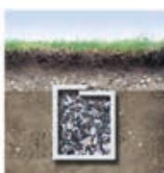
Geotextilie Fibertex chrání drenážní systém tím, že brání mísení jemné frakce.
