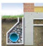
V základech konstrukce a v suteréních zdech zajišťuje geotextilie Fibertex čistou a obvodovou drenáž, která např. zamezuje škodám způsobeným vlhkostí.
