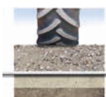
Geotextile Fibertex, položené pod horní vrstvu štěrku zvyšuje nosnost silnice a odolávají trvalému zatížení při hustém provozu. Automobily, traktory ani jiná vozidla se neboří do štěrku.
