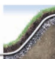
Díky geotextili Fibertex pod horní vrstvou odolávají svah podložní vodě, dešťové vodě i vodě z rozpuštěného sněhu, která by jinak vyplavovala jemnou frakci.
