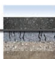
Bitumenová geotextile Fibertex AM-2 absorbuje zatížení od trhlin a spojů ze starých povrchů a brání jejich šíření do vrchních vrstev skrz kompositové vrstvy Densiphalt.
