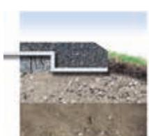
Geotextile Fibertex zajíždí separaci a stabilitu mezi podložní zeminou a přidanými materiály pro stavbu silnic.
