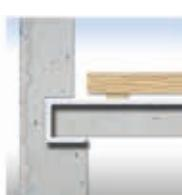
V obytných blocích se geotextile Fibertex používají pro tlumení zvuků.
