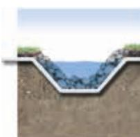
Geotextilie Fibertex chrání břehy řek a kanály účinným a životním prostředím příznivým způsobem.
