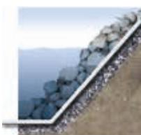
Geotextilie Fibertex chrání pobřežní zónu, protože jeho pružnost a propustnost tlumí nárazy vln a proudů, zabraňuje erozi a vyplavování jemné frakce.
