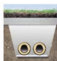
Uložením geotextile Fibertex pod dno příkopu se značně zvýší nosnost.
