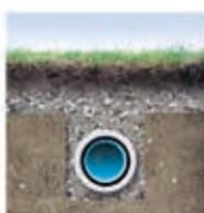
Obalením potrubí propustnou geotextilií Fibertex se zajistí účinný a trvalý drenážní systém bez nebezpečí zanesení.
