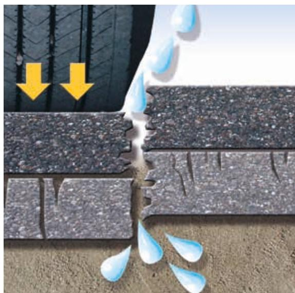
Fig. 2. Sans la nappe AM-2 les fissures de réflexion se créent sur les 2 couches solidaires. Les eaux de ruissellement peuvent facilement éroder les couches support de la chaussée.
