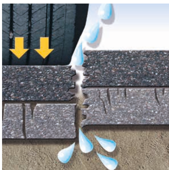
Fig. 2 Sin el geotextil de pavimentación se producirá una rápida reflexión de las grietas desde la antigua a la nueva capa asfáltica y además el agua superficial penetrará sobre la capa antigua de asfalto. Esta situación acelerará el deterioro en la construcción de la carretera.
