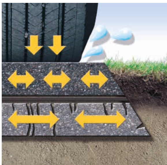
Fig. 1 Asfaltdugen absorberer differentialbevægelser i asfaltagene og modvirker refleksionsrevner. Desuden danner den et vandbeskyttende mellemlag, der forhindrer overfladevand i at trænge ned i den gamle belægning.
