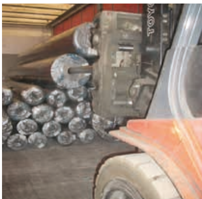
Figure 8.1: Déchargement des rouleaux utilisant un chariot élévateur équipé d'un éperon
