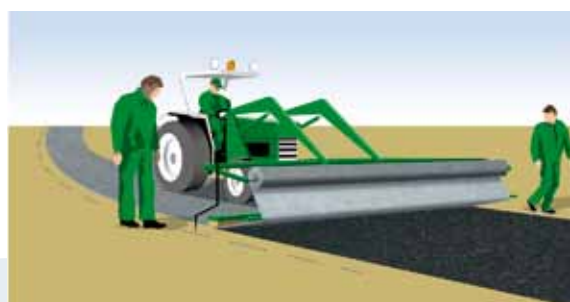
Рис 6. Механическое раскатывание Fibertex AM2 Special отличается быстротой и позволяет избежать складок даже на плавных изгибах пути.
