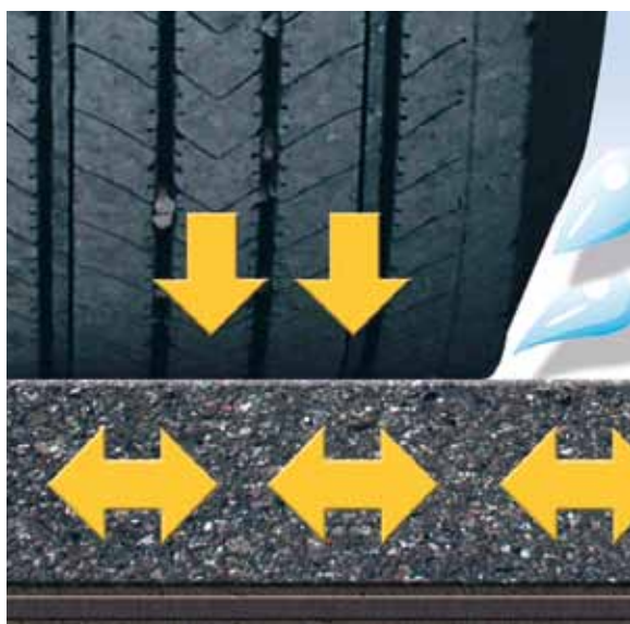
Рис. 1. Ткань для дорожного покрытия поглощает разницу в смещениях слоёв асфальта, предотвращая отражающее растрескивание. Кроме этого, она образует водонепроницаемую мембрану, защищающую старый слой асфальта от проникновения в него влаги с поверхности.
