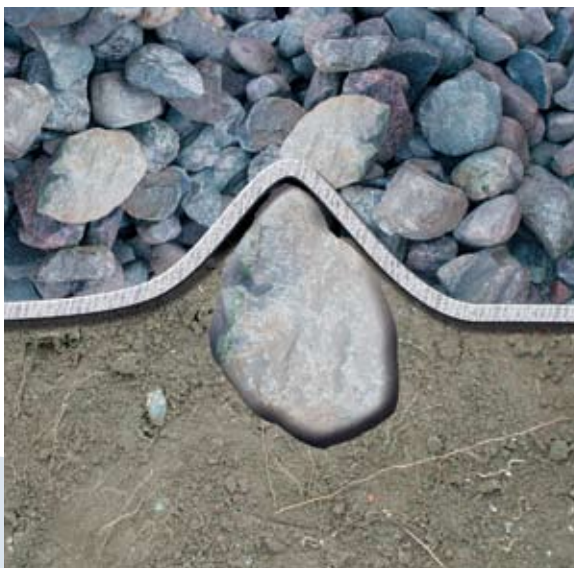
Fig.3. Elevada capacidade de alongamento e resistência á perfuração estática permitem ao geotêxtil acomodar-se ás superfícies irregulares.
