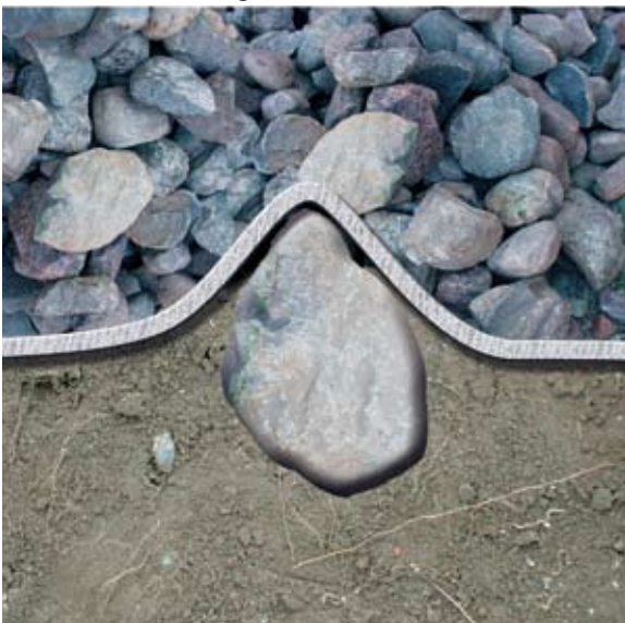
Fig.5. Elevada capacidade de alongamento e resistência à perfuração permitem que o geotêxtil se molde em redor de superfícies irregulares.
