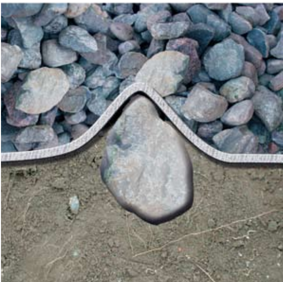
Fig. 5. Allongement élevé et résistance au poinçonnement statique permettent au géotextile d'épouser la surface irrégulière de la construction.
