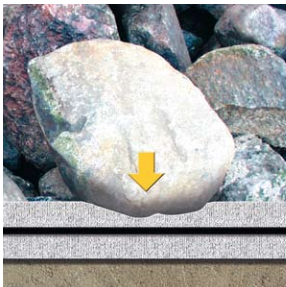
Fig. 11. Tilpasset tykkelse punkteringsmodstand forhindrer beskadigelse af den vandbeskyttende membran.
