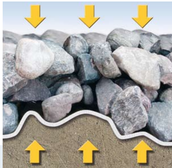
Fig. 4. Stor forlængelse og dynamisk perforeringsmodstand forhindrer punktering, når tryk fra fyldmaterialet forårsager bevægelse af fin jord mod huller i materialelaget.
