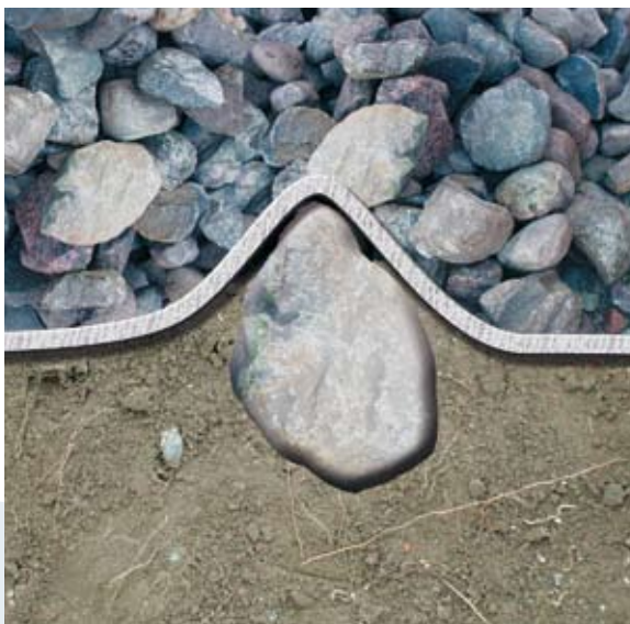
Fig. 3. Stor forlængelse og dynamisk perforeringsmodstand tillader geotekstilet at tilpasse sig til den ujævne konstruktoverflade.
