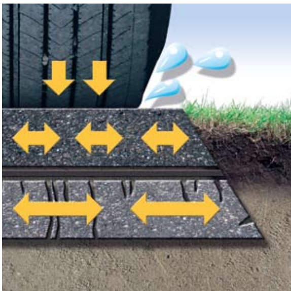
Fig. 1. La nappe d'AM2 absorbe les mouvements différentiels de dilatation à l'interface des couches d'enrobé. Cette nappe saturée de bitume est par nature étanche et empêche la pénétration des eaux de ruissellement.
