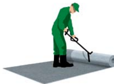
Fig. 5. Lorsque la nappe Fibertex AM2 est déroulée manuellement, l'utilisation d'un «pousseur» permet de respecter plus facilement la direction et d'éviter la formation de plis.
