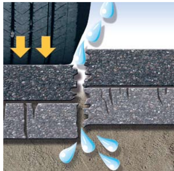
Fig. 2. Sans la nappe AM2 les fissures de reflexion se creent sur les 2 couches solidaires. Les eaux de ruissellement peuvent facilement eroder les couches support de la chaussée.
