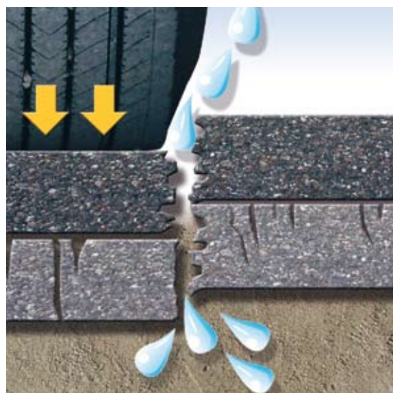
Fig. 2. Uden asfaltdug vil refleksionsrevner forekomme i det nye asfaltslidlag, og overfladevand vil trænge ned i den gamle asfaltbelægning. Det kan fremskynde skader af hele vejkonstruktionen.
