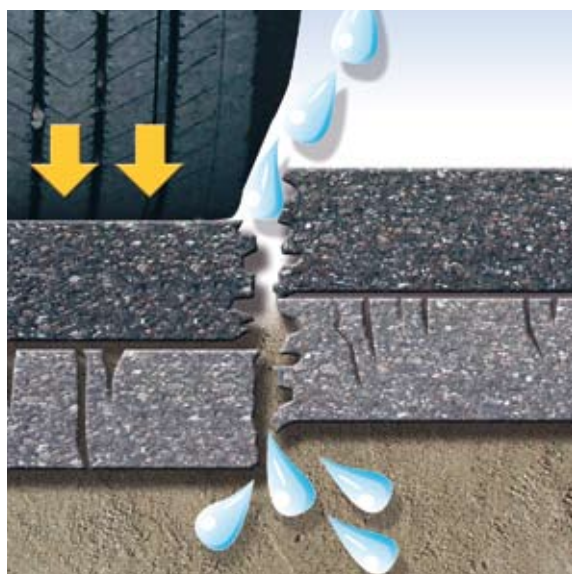
Fig2 – Sem aplicação de geotêxtil de pavimentação, irão aparecer fissuras na nova camada de asfalto que se propagam da base para o topo, devido à entrada de água na antiga camada de asfalto. Este processo irá acelerar a deterioração de toda a construção da estrada.
