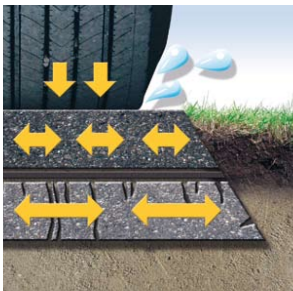
Fig1 – O geotêxtil utilizado na pavimentação absorve movimentos diferenciais nas camadas de asfalto, prevenindo o aparecimento de fissuras. Para além disso, forma uma inter camada à prova de água que previne a entrada de água superficial na antiga camada de asfalto.
