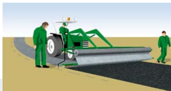
Fig. 6. Desenrolar mecanicamente Fibertex AM2 é menos moroso e minimiza o número de dobras mesmo nas curvas menos acentuadas.
