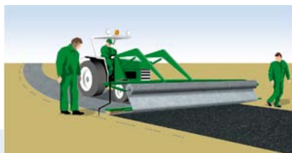
Fig. 6 El desenrollado de Fibertex AM2 Special con equipos mecánicos es rápido y está libre de arrugas incluso en las curvas suaves.
