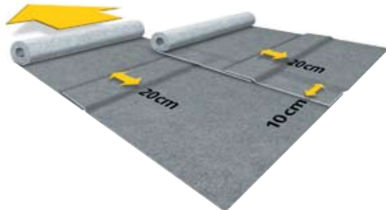
Fig. 7 Se recomiendan solapes suficientes en la dirección transversal y en la longitudinal.
