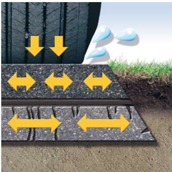
Fig. 1 El geotextil de pavimentación AM2, absorbe los movimientos diferenciales entre capas asfálticas lo que evita la formación de grietas por reflexión. Además forma una capa intermedia impermeable que evita que el agua superficial penetre en la capa antigua.
