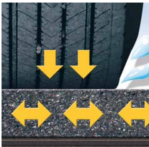
Obr. 1. Vozková textilie absorbuje diferenční pohyby v asfaltových vrstvách a zabraňuje šíření trhlin. Navíc tvoří vodotěsnou mezivrstvu, která brání povrchové vodě v pronikání do vrstvy starého asfaltu.
